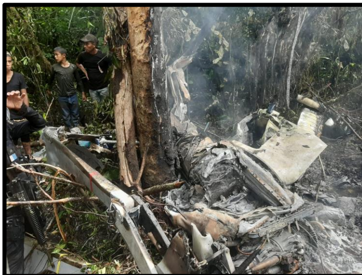
Fotografía No. 9 Restos de los componentes del rotor principal y fuselaje.
